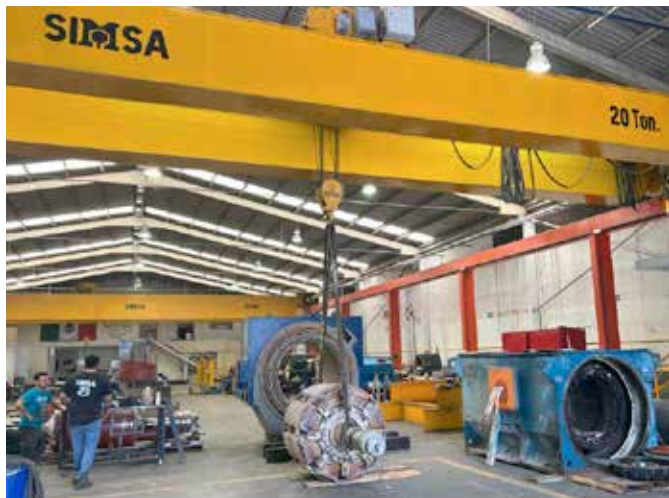
Desensamble de un motor sincrónico de 8000 HP 8 polos para industria cementera.
