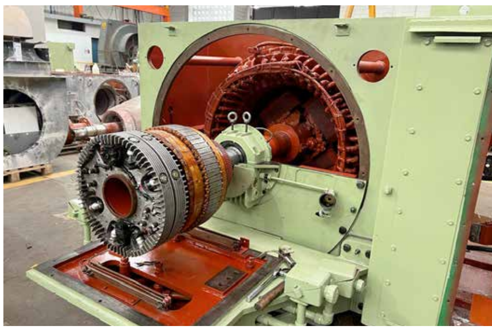
Rebobinado completo de excitatriz de motor sincrónico de 5000 HP 4 polos para industria de la petroquímica.
